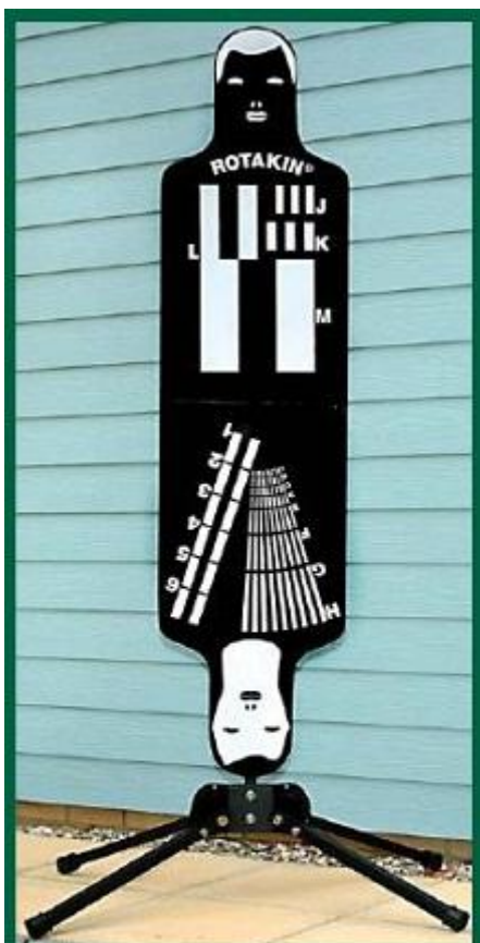
Ротакин – плоский манекен, применяемый для оценки эффективности систем видеонаблюдения. Такой подход рекомендован научным подразделением МВД Великобритании и Ассоциацией индустрии безопасности Великобритании.
