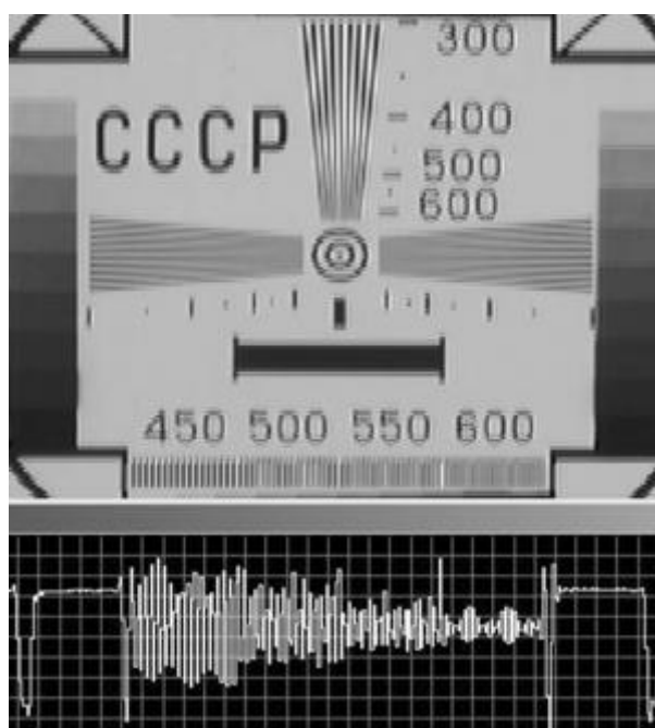
Рис.3 Иллюстрация изображения муаров вертикального клина тест-таблицы, наблюдаемой телевизионной камерой на матрице ПЗС.
