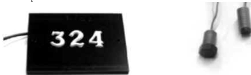
Фото 2. ИК-осветители в виде номера квартиры, болта и шпильки.
