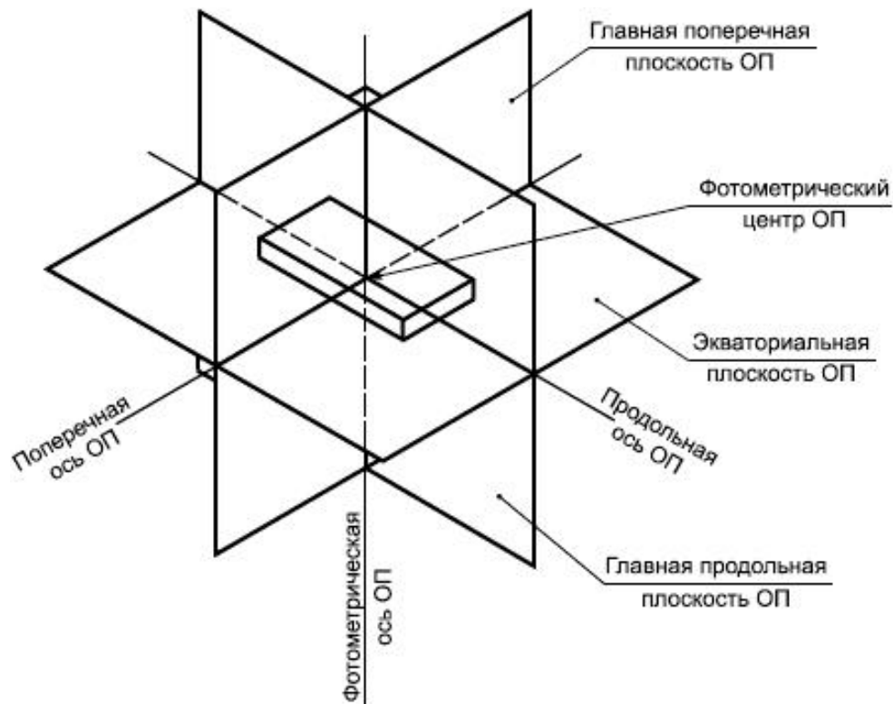
Рисунок Б.1 - Главные оси и плоскости осветительного прибора
