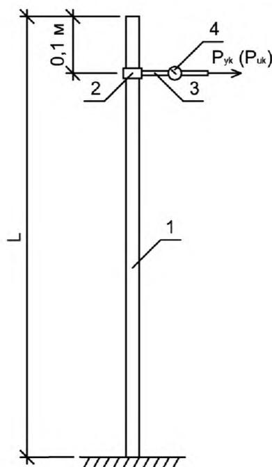
1 — опора; 2 — хомут; 3 — стальной канат; 4 — динамометр; L — длина опоры; P<sub>ук</sub> — контрольная испытательная нагрузка при испытании на жесткость; P<sub>ук</sub> — контрольная испытательная нагрузка при испытании на прочность
