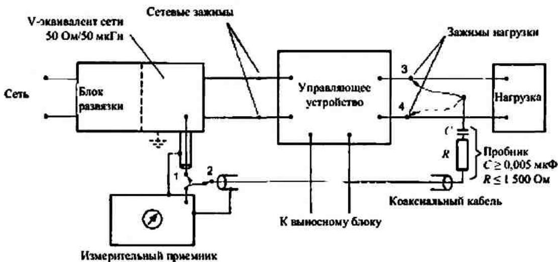
1 – для измерений на сетевых зажимах; 2 – для измерений на зажимах нагрузки;
