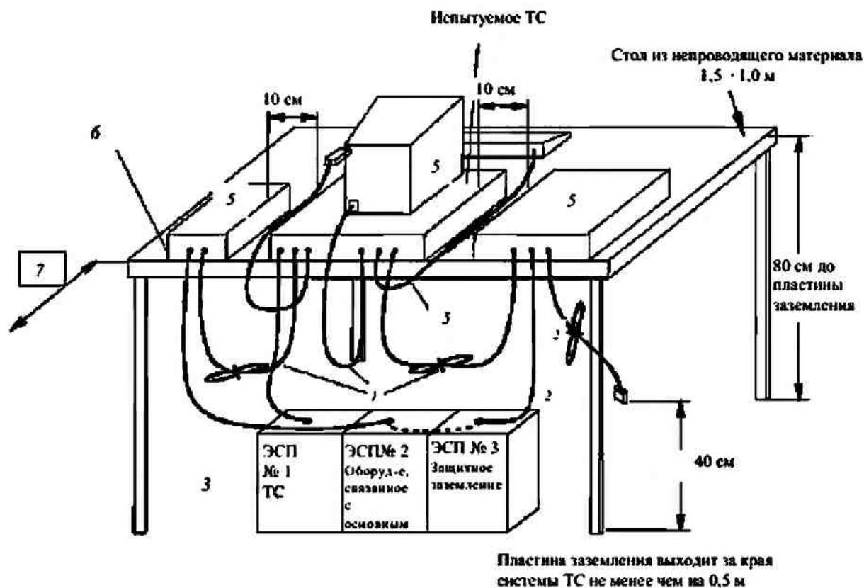
1 – соединительные кабели, удаленные от пластины заземления менее чем на 40 см, уложены в плоские петли (от 30 до 40 см) и вывешены приблизительно в середине между столом и пластиной заземления;
