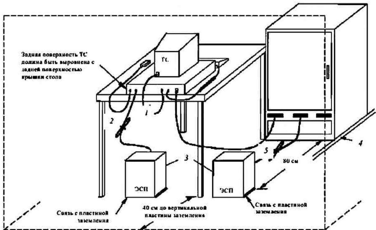
1 – соединительные кабели, удаленные от пластины заземления менее 40 см, уложены в плоские петли (от 30 до 40 см) и вывешены приблизительно в середине между столом и пластиной заземления;
