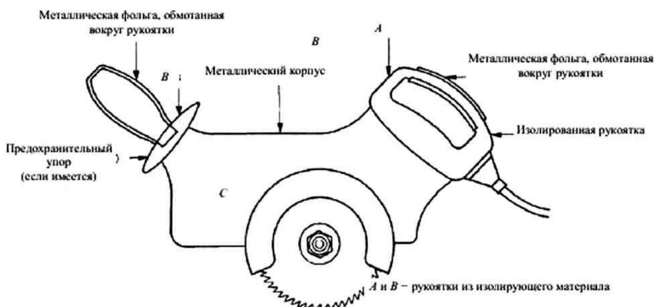
Рисунок 14 – Переносная электрическая пила с эквивалентом руки (см. 7.4.2.3)
