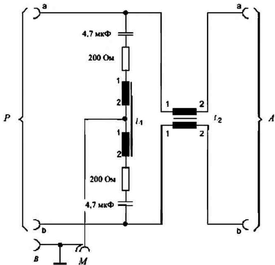
*I* – начало обмотки; *2* – конец обмотки; *A* – зажимы для подключения линии связи;
