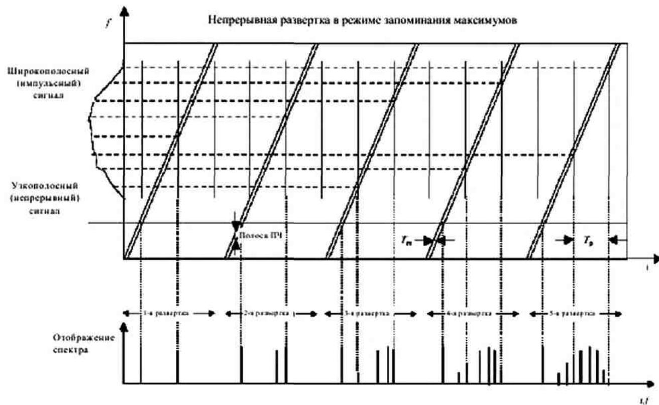
$T_p$  – период повторения импульсов широкополосных ИРП. Моменты появления импульсов показаны вертикальными линиями на верхней части рисунка.
