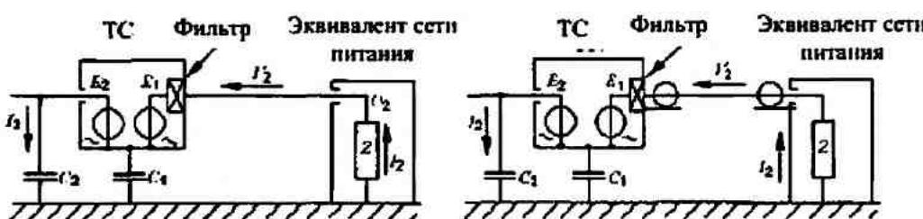
Рисунок А.3 – ТС с хорошей фильтрацией, но с неполным экранированием (эквивалентная схема 3)
