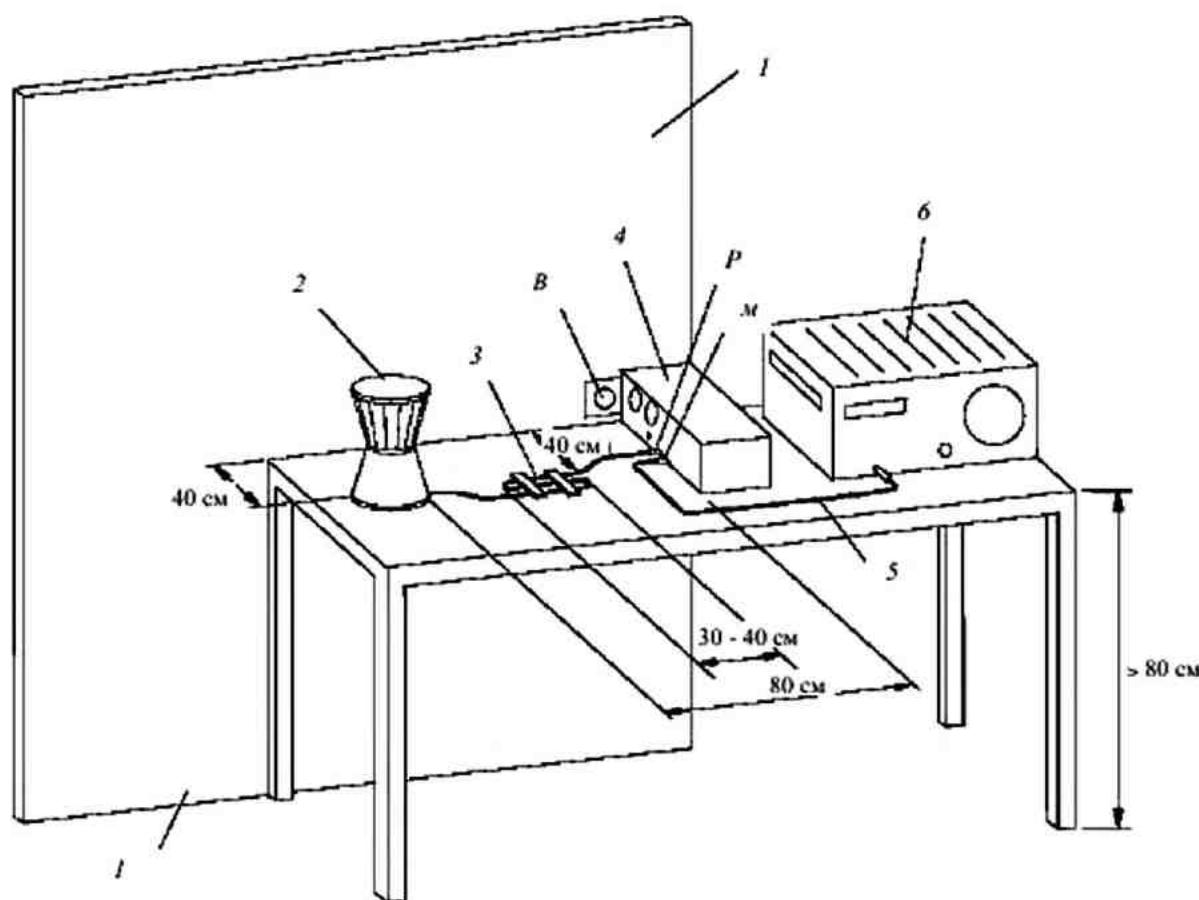
1 – металлическая стена  $2 \cdot 2\text{м}$ ; 2 – испытуемое ТС; 3 – излишек сетевого шнура, уложенный плоскими петлями  $3 \cdot 40\text{ см}$ ; 4 – V-образный эквивалент сети; 5 – коаксиальный кабель; 6 – измерительный приемник; В – соединение с опорным заземлением; М – вход измерительного приемника; Р – питание испытуемого ТС
