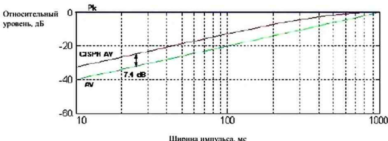
Рисунок D.3 – Пример весовых функций (импульс 1 Гц) при детектировании пиковым детектором  $PK$  и детектором средних значений  $AV$  относительно ширины импульсов для постоянной времени прибора 160 мс
