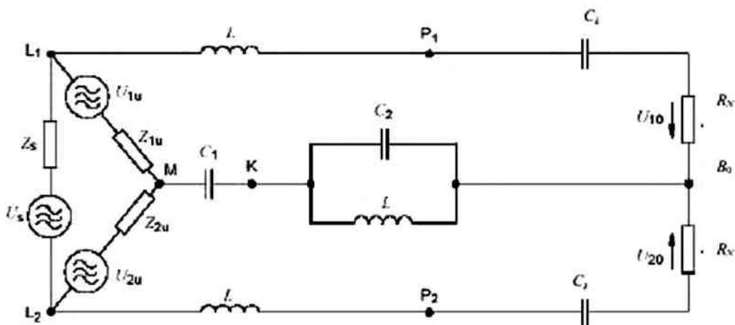
б) Эквивалентная схема источника ВЧ помех и схема измерения
