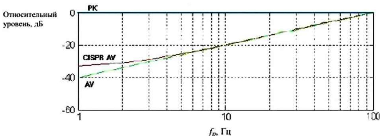
Рисунок D.1 – Весовая функция импульса 10 мс при детектировании пиковым детектором *PK*, детектором средних значений при учете пиковых значений *CISPR AV* и детектором средних значений без учета пиковых значений *AV* для постоянной времени прибора 160 мс
