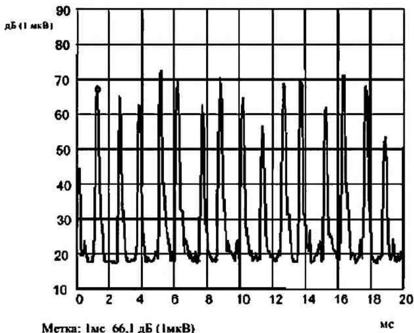
ИРП от коллекторного двигателя, работающего от источника постоянного тока. Из-за большого количества коллекторных сегментов частота повторения импульсов высокая (приблизительно 800 Гц) и амплитуда импульсов существенно изменяется. Следовательно, в этом примере рекомендуемое время измерения  $> 10$  мс при пиковом детектировании
