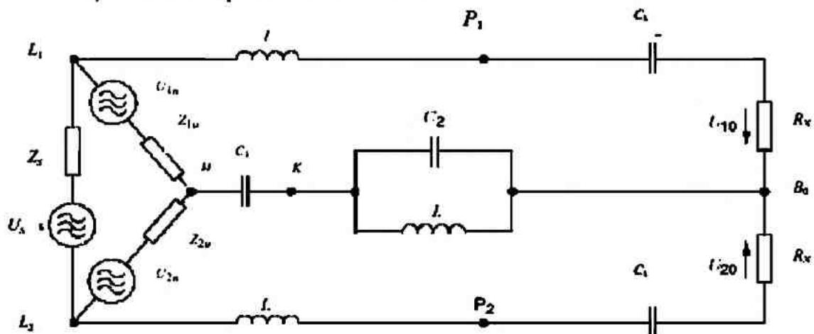
b) Эквивалентная схема источника напряжения и схема измерения
