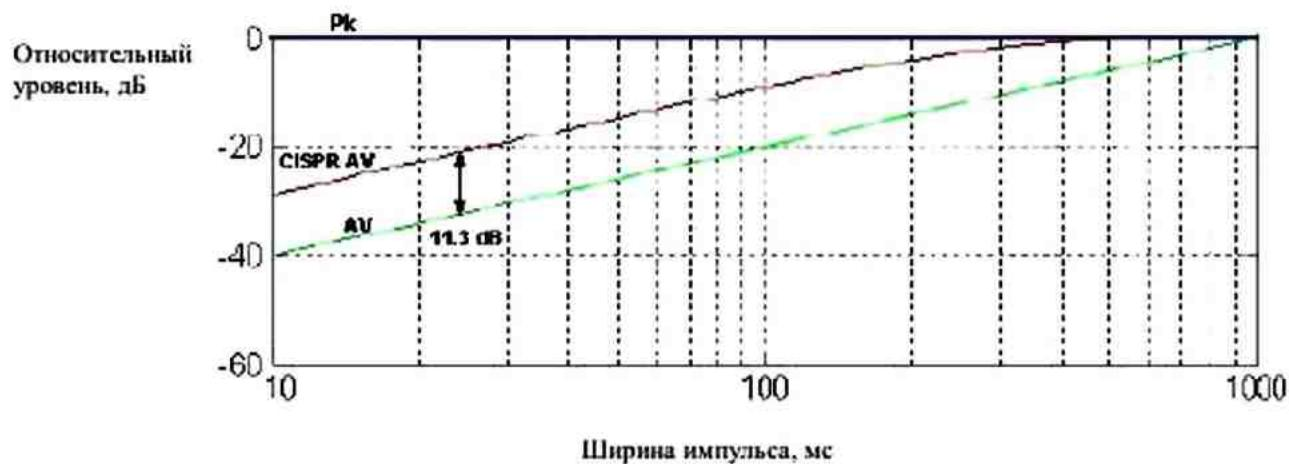
Рисунок D.4 – Пример весовых функций (импульс 1 Гц) при детектировании пиковым детектором  $PK$  и детектором средних значений  $AV$  относительно ширины импульсов для постоянной времени прибора 100 мс
