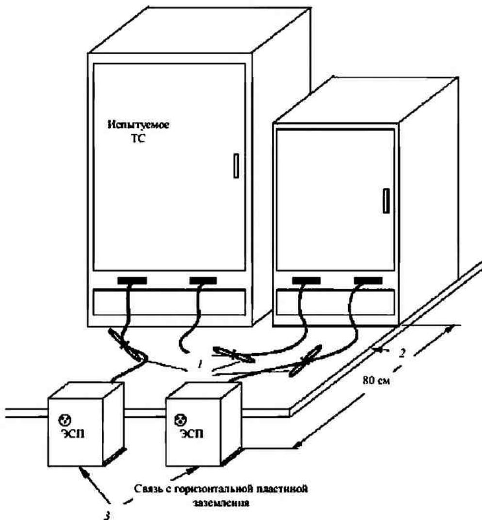
1 – кабели, имеющие излишнюю длину, укладывают в центре в виде плоских петель или укорачивают до соответствующей длины;
