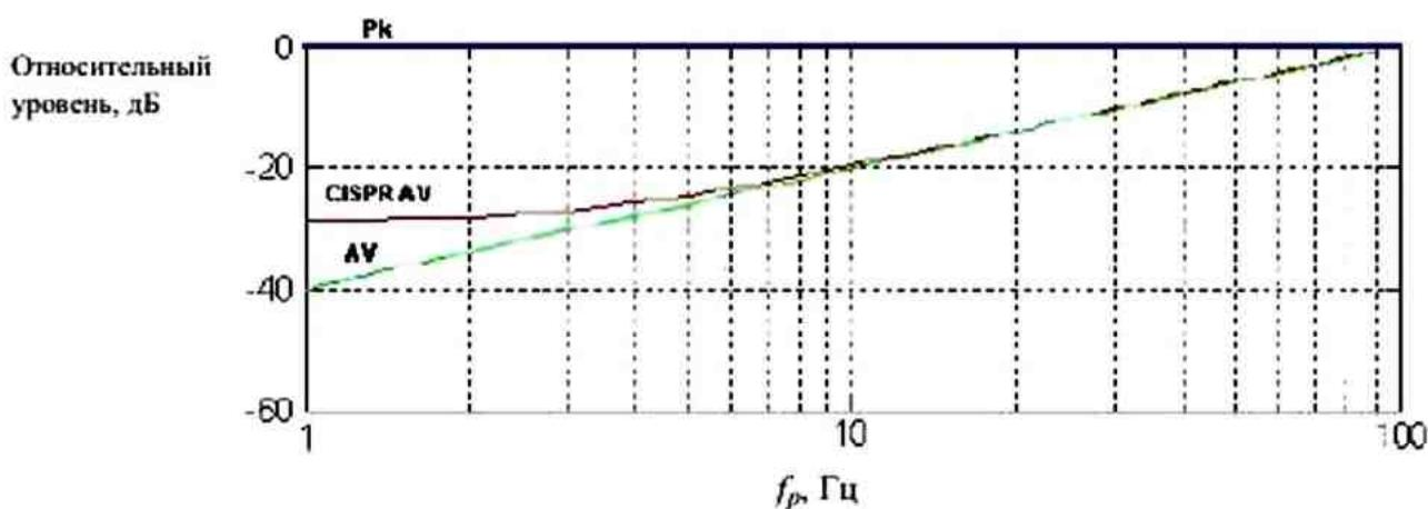
Рисунок D.2 – Весовая функция импульса 10 мс при детектировании пиковым детектором *PK*, детектором средних значений при учете пиковых значений *CISPR AV* и детектором средних значений без учета пиковых значений *AV* для постоянной времени прибора 100 мс
