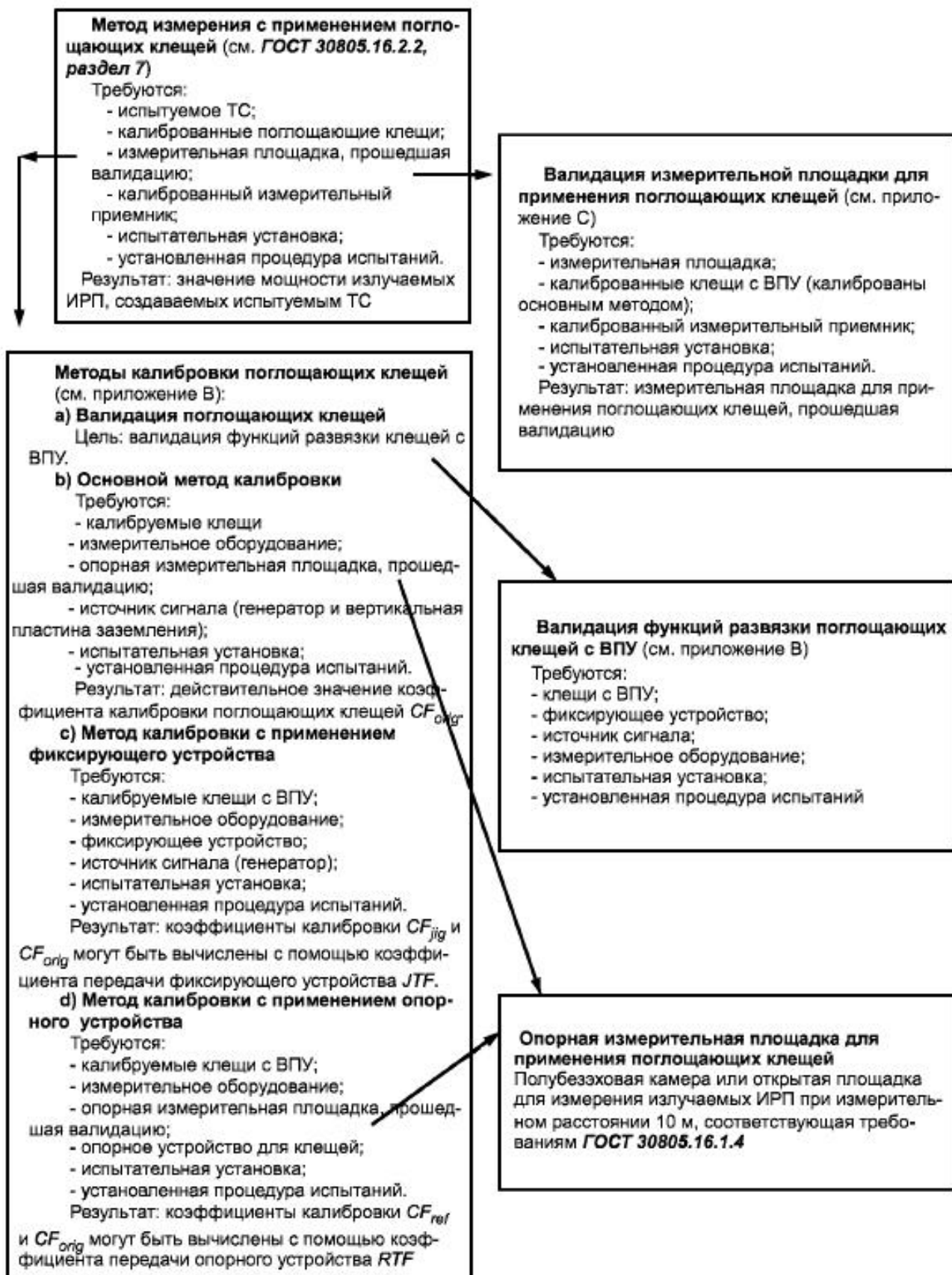
Рисунок 1 - Сведения о методе измерения с применением поглощающих клещей, оборудовании, необходимом для применения данного метода, а также о методах калибровки и валидации этого оборудования
