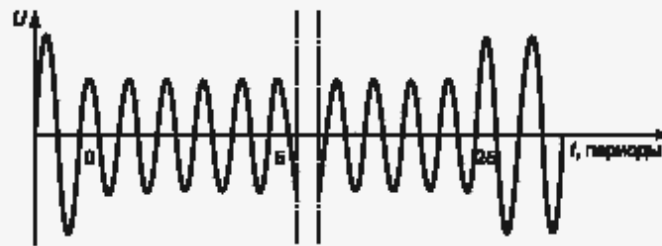
а) Форма провала напряжения при понижении напряжения до 70 % U_T в течение 25 периодов при переходе через нуль
