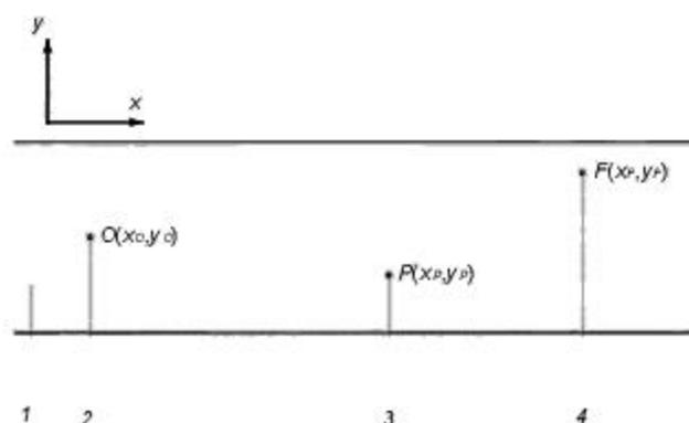
1 — дорога; 2 — проекция наблюдателя на дорогу; 3 — расчетная точка; 4 — проекция ОП на дорогу
