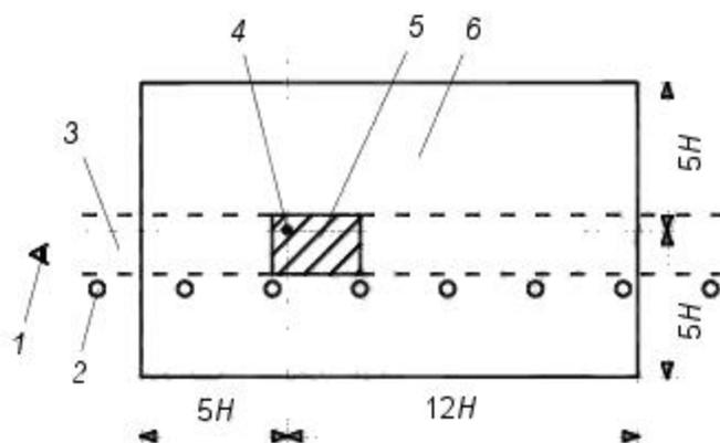
1 – наблюдатель; 2 – ОП; 3 – дорога; 4 – расчетная точка; 5 – расчетное поле (заштриховано); 6 – поле ОП, включенных в расчет
