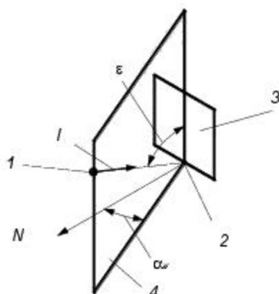
1 – ОП, 2 – расчетная точка, 3 – плоскость окна, 4 – плоскость падения света,
