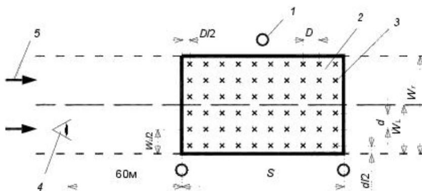
1 – светильник; 2 – расчетное поле; 3 – расчетные точки; 4 – наблюдатель;
