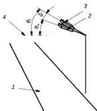
1 – дорога; 2 – ОП в положении при измерении; 3 – ОП в положении при использовании; 4 – горизонталь
