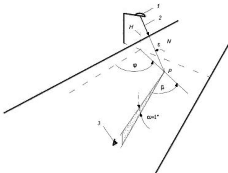
1 – ОП; 2 – луч света в расчетную точку  $P$ ; 3 – глаз наблюдателя;  $H$  – высота светового центра ОП над поверхностью дороги;  $N$  – нормаль к поверхности дороги в точке  $P$ ;  $\beta$  – угол отклонения;  $\varepsilon$  – угол падения света;  $\alpha$  – угол наблюдения;  $\varphi$  – азимутальный угол точки  $P$
