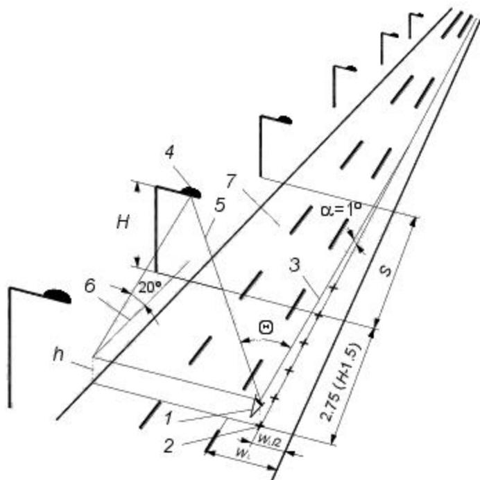
1 – глаз наблюдателя, 2 – точки расположения наблюдателя, 3 – линия зрения, 4 – ОП; 5 – плоскость экранирования, 6 – линия горизонта, 7 – расчетное поле
