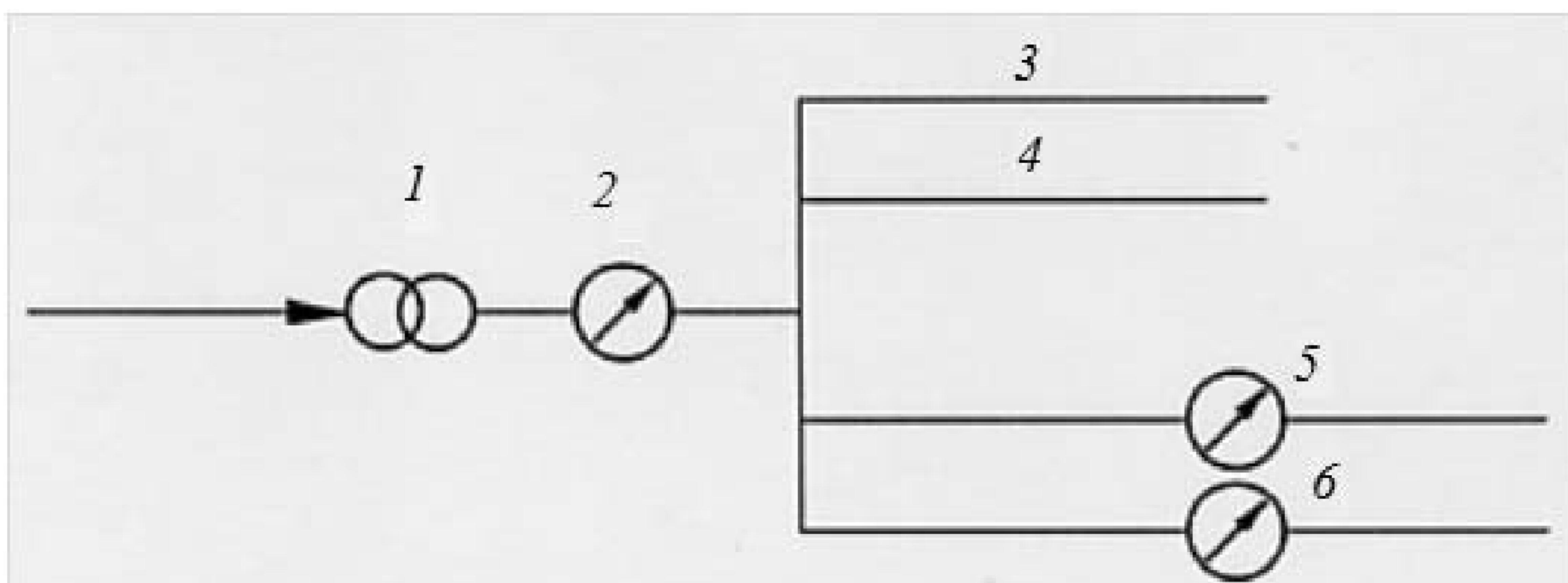
1 – основной источник электропитания; 2 – счетчик электроэнергии в киловатт-часах – полная энергия; 3 – цепь питания электрооборудования 1; 4 – цепь питания электрооборудования 2; 5 – счетчик электроэнергии в киловатт-часах – цепь электропитания освещения 1; 6 – счетчик электроэнергии в киловатт-часах – цепь электропитания освещения 2
