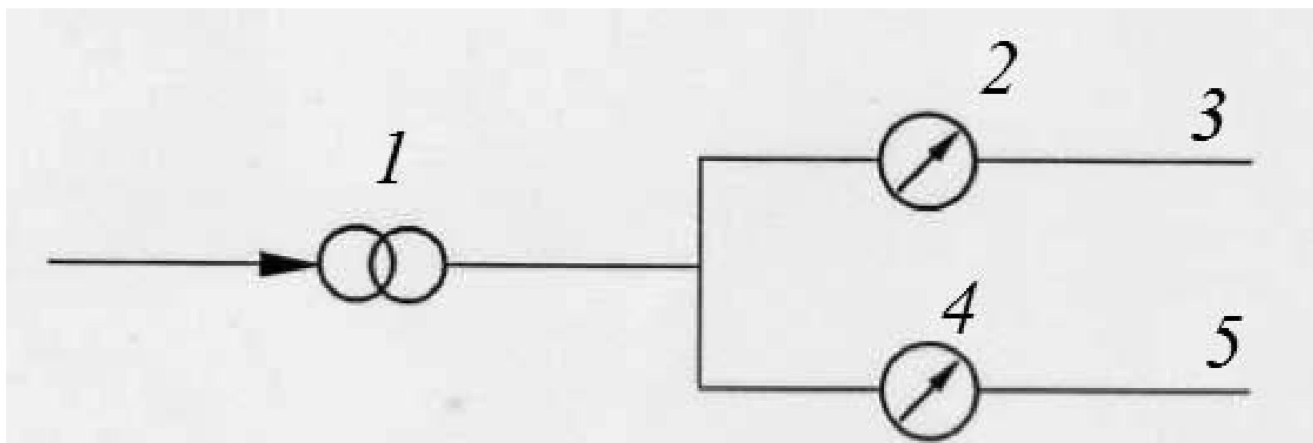
1 – основной источник электропитания; 2 – другие цепи счетчика электроэнергии в киловатт-часах; 3 – цепь питания электрооборудования; 4 – счетчик расхода энергии на освещение в киловатт-часах; 5 – цепь электропитания освещения
