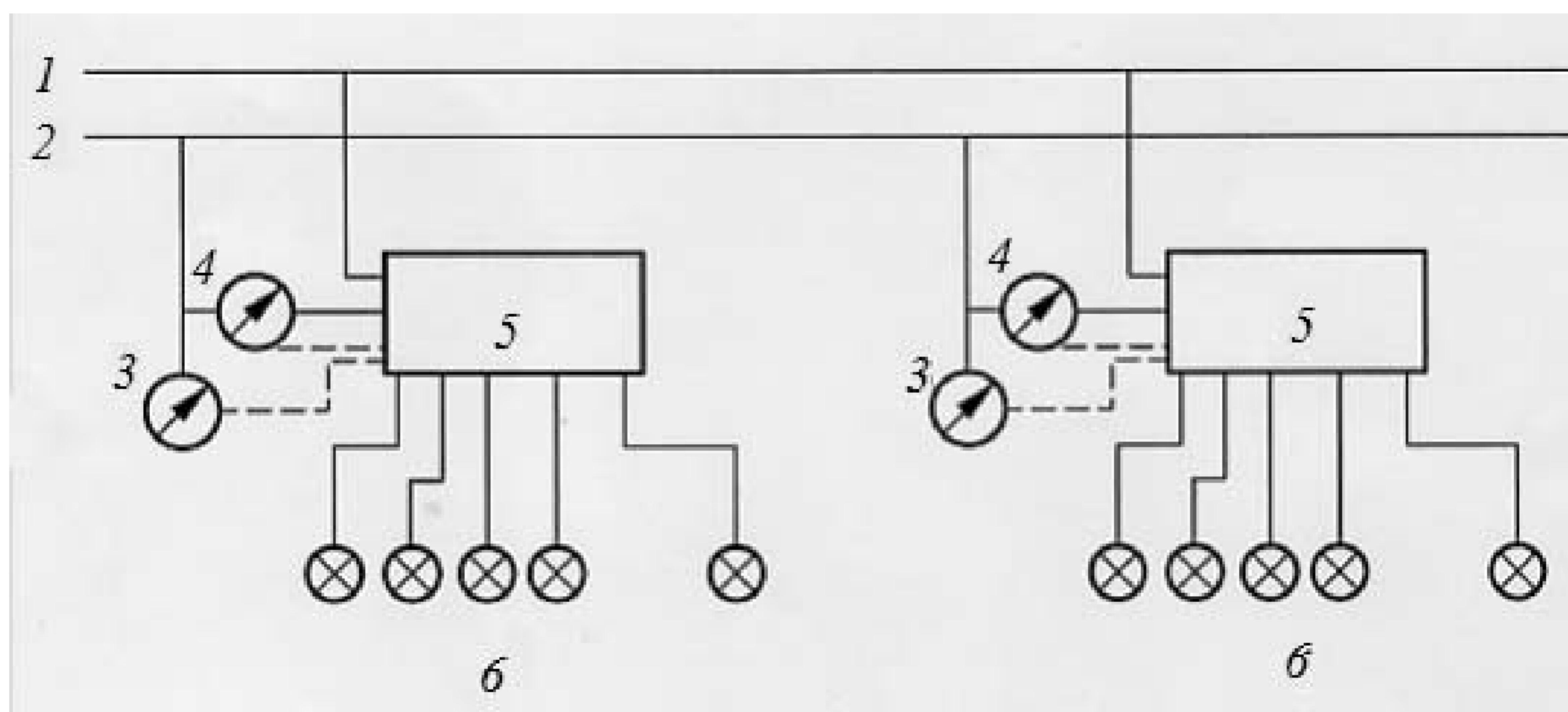
1 – шина электропитания освещения; 2 – источник питания 220 В;
