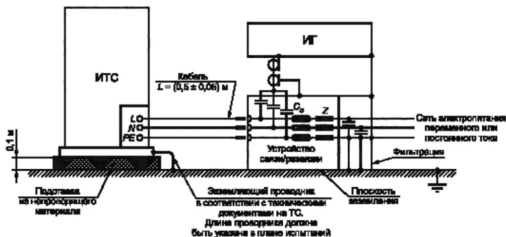
**П р и м е ч а н и е** — Длина кабелей электропитания между устройством связи/развязки и ИТС может быть увеличена до 1 м, если это установлено в стандарте на группу ТС или ТС конкретного вида.
