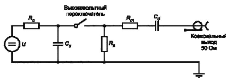
U — источник высокого напряжения;  $R_c$  — зарядный резистор;  $C_c$  — накопительный конденсатор,  $R_z$  — резистор цепи формирования длительности импульса;  $R_m$  — согласующий резистор;  $C_s$  — разделительный конденсатор
