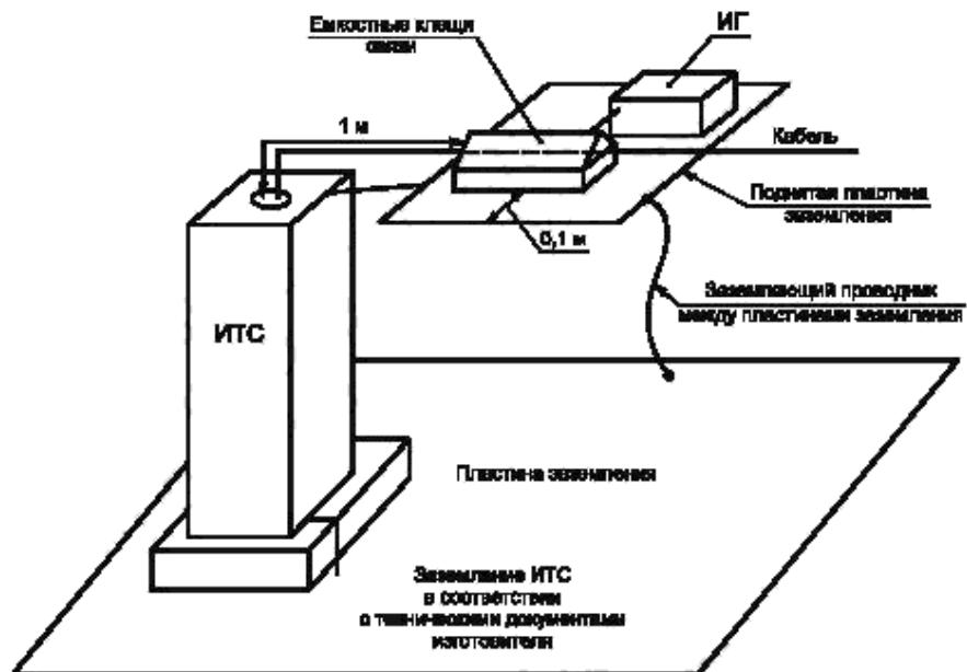
**П р и м е ч а н и е** — Допускается установка емкостных клещей связи на стене скранированного помещения или на другой заземленной поверхности. Емкостные клещи связи соединяют с корпусом ИТС. При испытаниях на полных ИТС значительных размеров с кабелями, выводимыми наверху, допускается установка клещей связи на высоте 10 см над центром ИТС. При этом кабели, подключаемые к емкостным клещам связи, пропускают через центр пластины заземления клещей.
