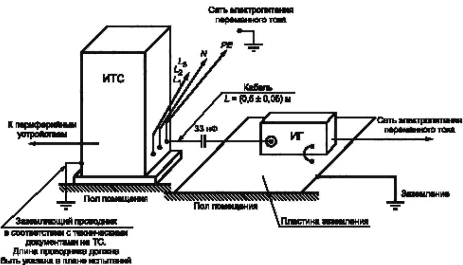
**П р и м е ч а н и е** — При подаче НИП на порт заземления разделительный конденсатор емкостью 33 нФ применяют при необходимости.
