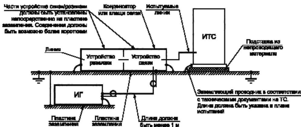
Рисунок 6 — Схема испытаний ТС на устойчивость к НИП
