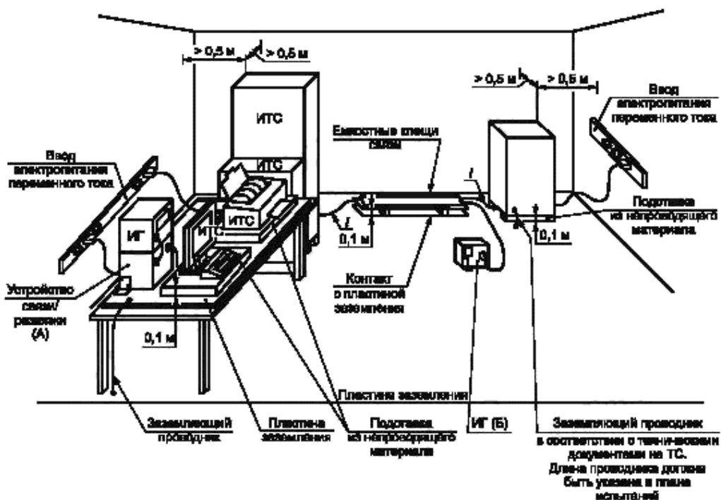
А — размещение устройства связи/развязки для подачи НИП на линии электропитания; Б — размещение ИГ для подачи НИП на сигнальные линии
