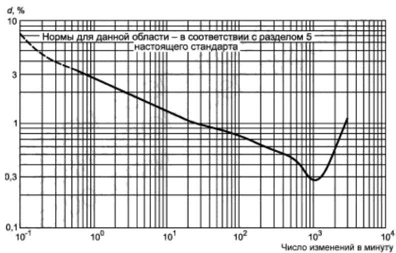
П р и м е ч а н и е — Частота повторения изменений напряжения  $1200 \text{ мин}^{-1}$  соответствует фликеру с частотой 10 Гц
