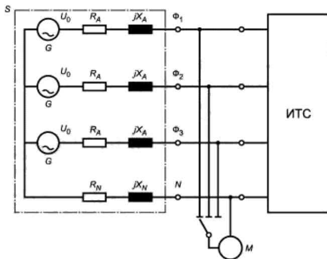
$M$  — средство измерений;  $G$  — генератор напряжения, соответствующий требованиям 6.3;  $S$  — источник электропитания, содержащий генератор напряжения  $G$  и стандартное полное сопротивление  $Z$ ;  $U_0$  — напряжение холостого хода источника электропитания;  $R_A, R_N$  — активные составляющие стандартного полного сопротивления  $Z$ ;  $jX_A, jX_N$  — реактивные составляющие стандартного полного сопротивления  $Z$ ;  $\Phi_1, \Phi_2, \Phi_3$  — фазные провода;  $N$  — нейтральный провод
